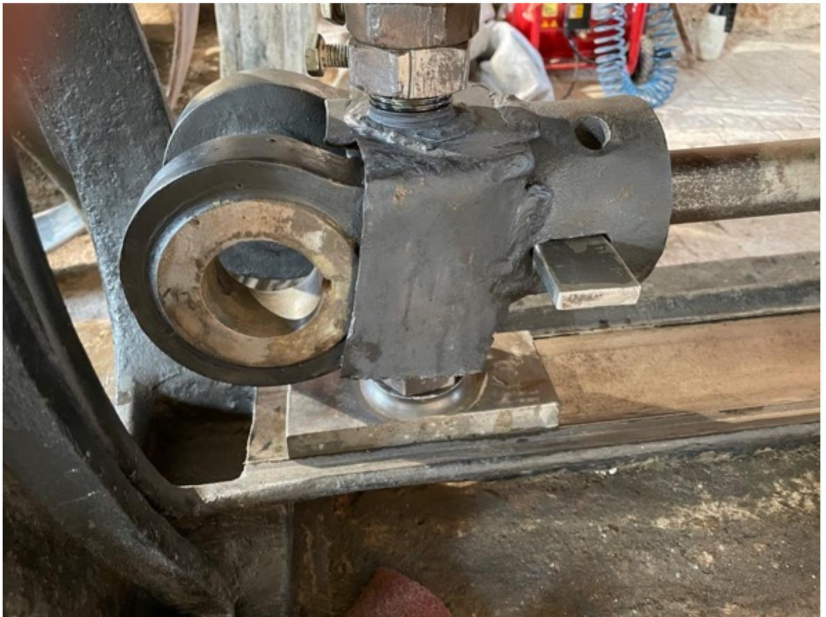
Kommentar: Überarbeitung Kurbelstange Kreuzkopf, Kolbenstange, Exzenterstangen
