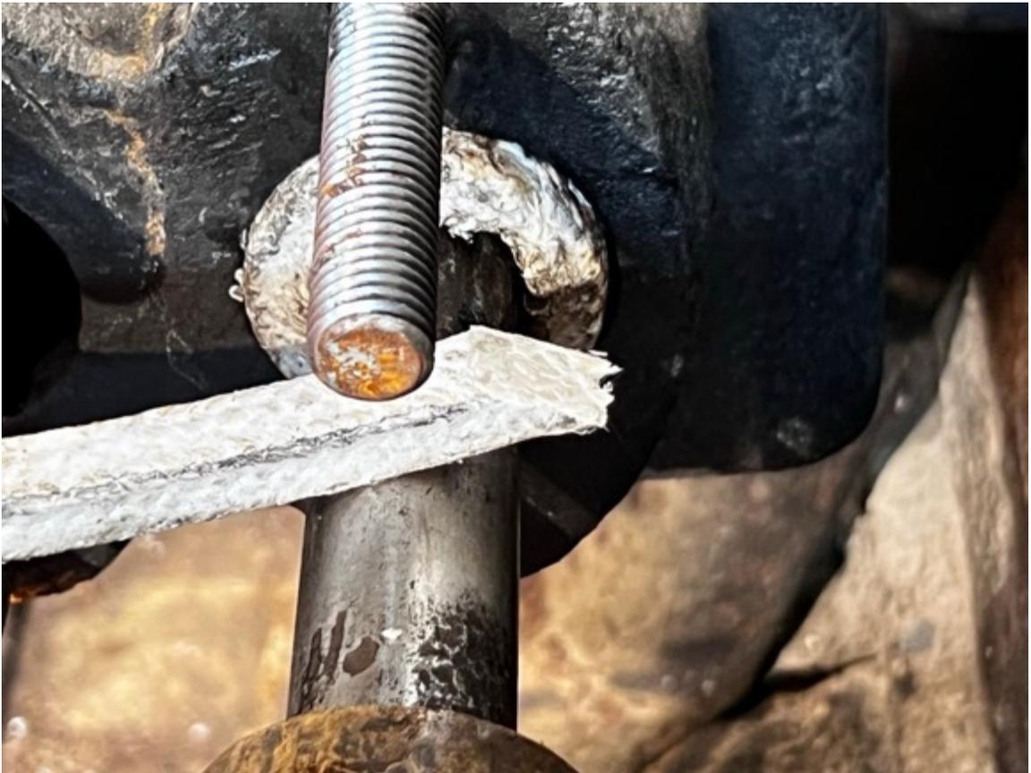
Kommentar: Überarbeitung Zylinder und Schieberkasten (außen und innen)/ Beispiel für die Erneuerung der Stopfenbuchsen
