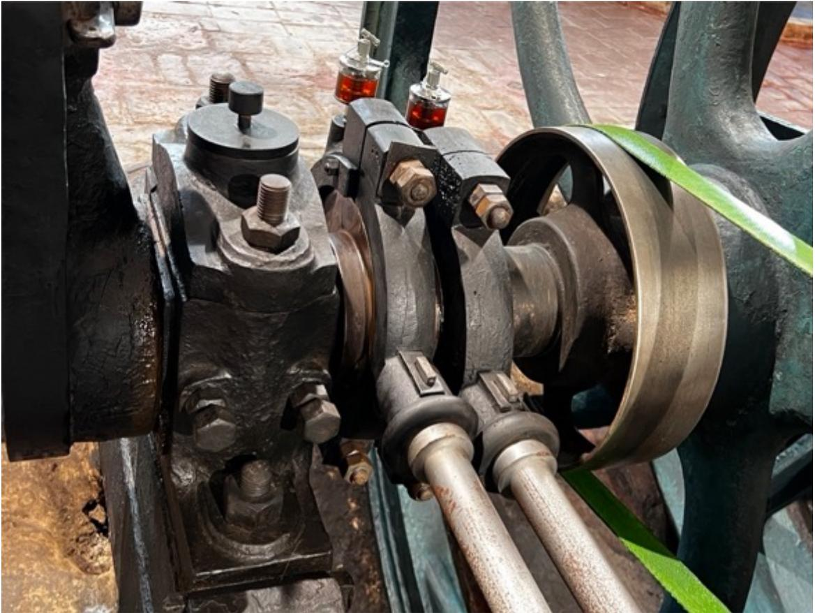
Kommentar: Überarbeitung Kurbelstange Kreuzkopf, Kolbenstange, Exzenterstangen mit neuen Ölern
