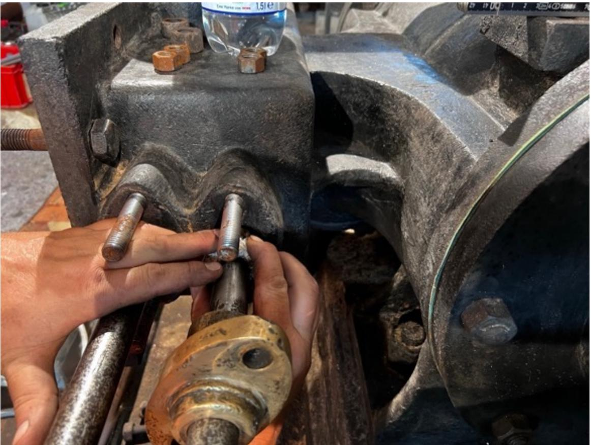
Kommentar: Überarbeitung Zylinder/ Einbau der Stopfenbuchsen und der neuen Brille
