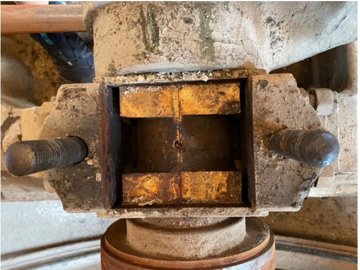
Kommentar: Teildemontage der Dampfmaschine/ Bsp. Für die Überarbeitung der Lager vom Schwungrad
