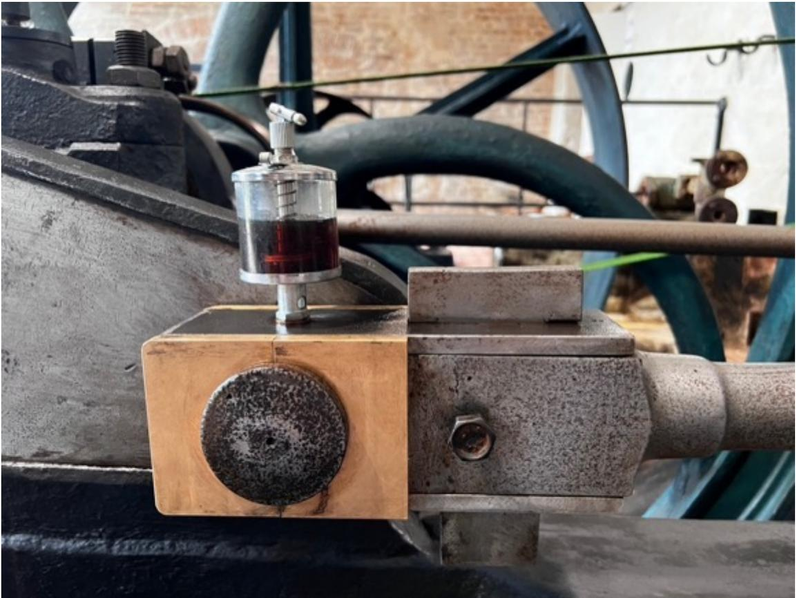
Kommentar: Überarbeitung Kurbelstange, Herstellung und Einbau der neuen Lagerschalen sowie ein Öler
