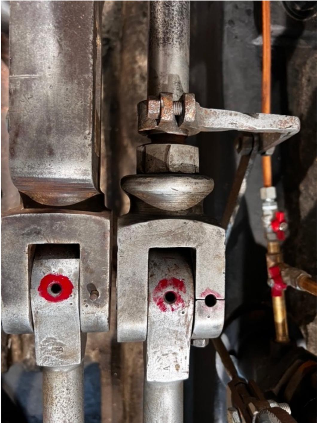
Kommentar: Überarbeitung Kurbelstange Kreuzkopf, Kolbenstange, Exzenterstangen
