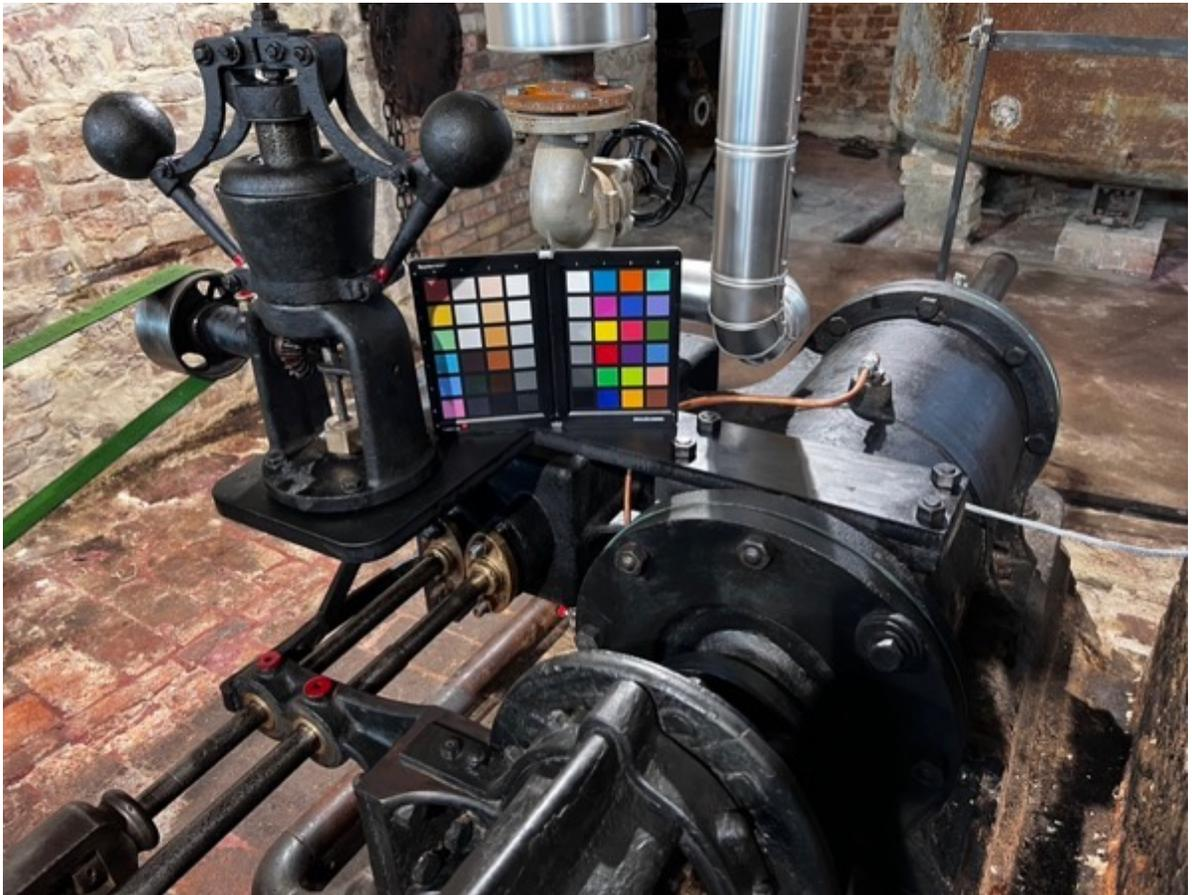
Kommentar: Überarbeitung Fliehkraftregler mit neuer Kontaktplatte und aufgelegten Flachriemen/Schmierölapparat Anschluss an den Zylinder
